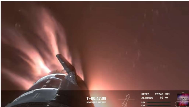
Fig. 1. Reentrada del Starship el 14 de Marzo de 2024 dónde se aprecia la formación del plasma. El “radio blackout” comienza a 75 km de altura, cuando reentra a una velocidad de 26623 km/h [https://www.youtube.com/watch?v=JX1LTw48ymQ].
