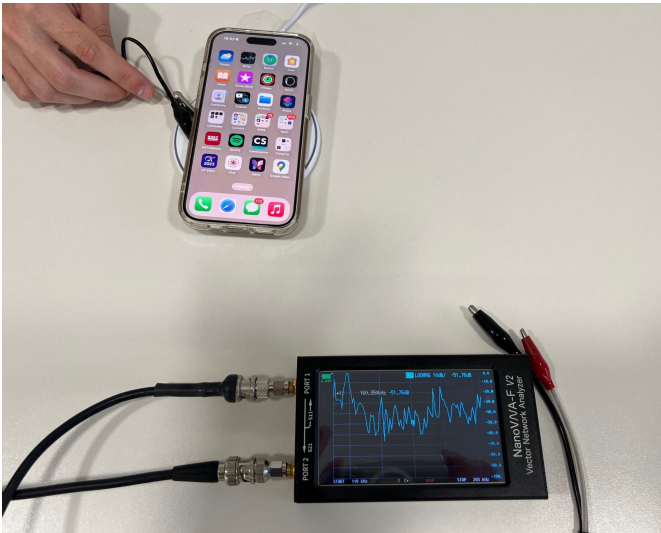
Fig. 8: Inducción sobre la bobina Rx creada por una base de carga comercial durante el proceso de carga.
